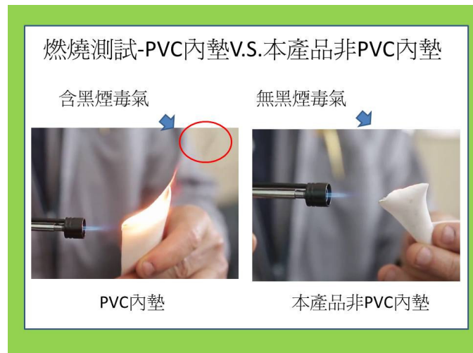
圖 4、傳統 PVC 內墊材料與本產品非 PVC 內墊材料燃燒測試比較
